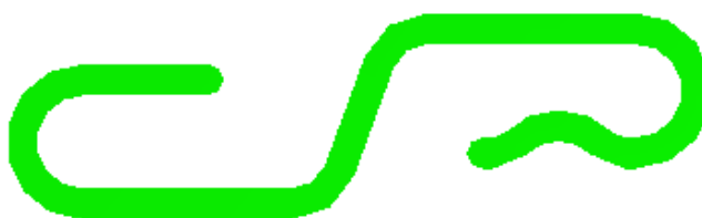
Figura 10.5 - Exemplo de perfil da carcaça inter-travada
